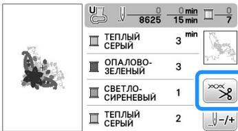
2 Для выключения функции автоматической обрезки нити нажмите кнопку
