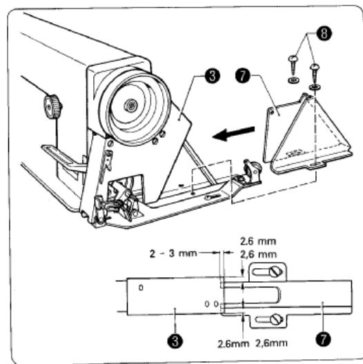
6. Наденьте кожух D (7) приводного ремня таким образом, чтобы он перекрыл на 2-3 мм кожух (3) приводного ремня, затем временно затяните два винта (8).
