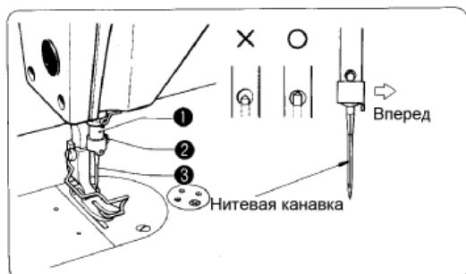
1. Поднимите иглодержатель (1) в крайнее верхнее положение поворотом махового колеса.
