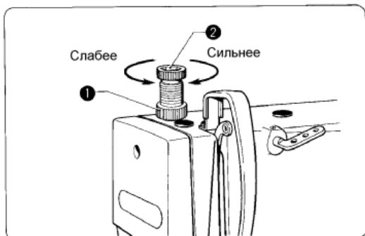
1. Ослабить регулировочную гайку (1).
