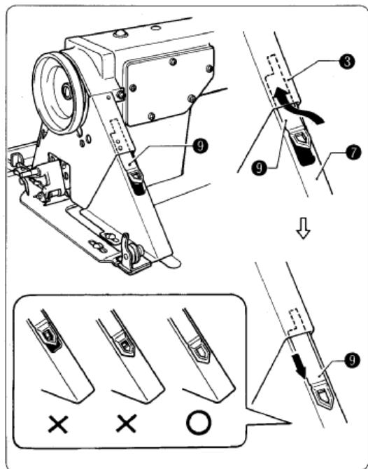
7. Вставьте крышку (9) кожуха D (7) между кожухом (3) и кожухом (7), и затем поместите ее в желобок кожуха D (7).
