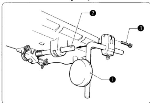
Поместите устройство поднятия нажимной лапки коленом (1) на ось (2), расположенную на масляном резервуаре, затем зафиксируйте ее, затянув болт (3).
