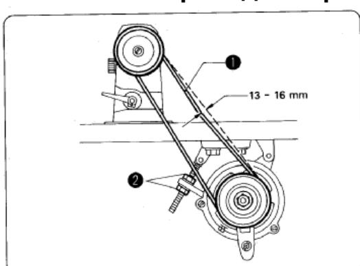
1. Наклоните машину назад и наденьте приводной ремень (1) на шкив двигателя и маховое колесо машины.
