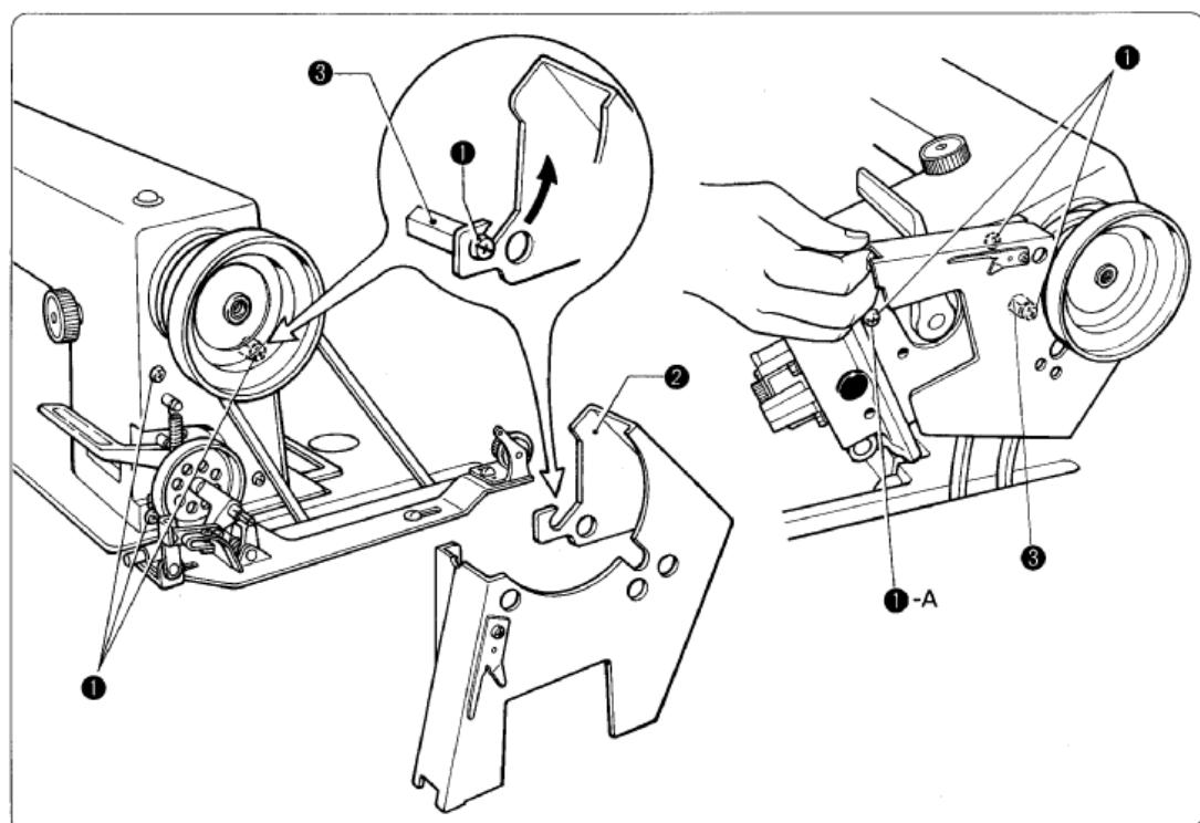
1. Ослабьте три винта (1) на боковой панели машины на 4 - 5 оборотов.
