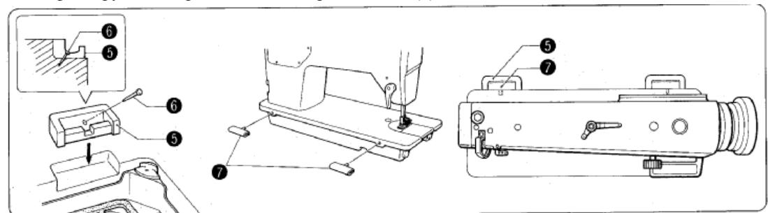
4. Вставьте две резиновые прокладки (5) в зарубки на рабочем столе и зафиксируйте их при помощи двух гвоздей (6).
