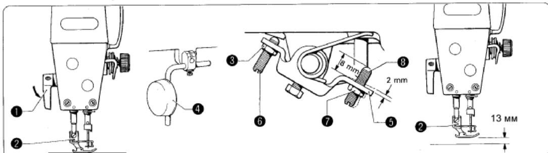
1. Опустите нажимную лапку (2) при помощи рычага поднятия лапки (1).
