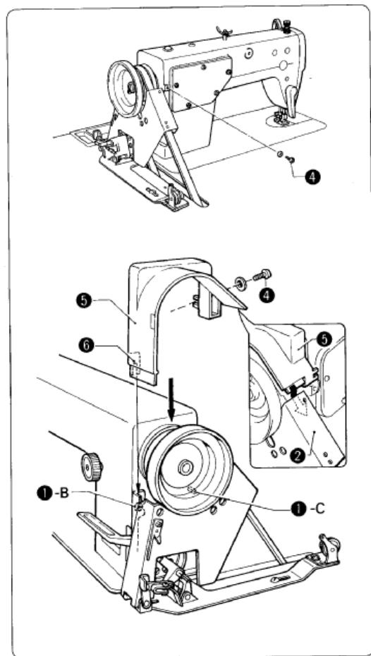
3. Верните машину в исходное положение, затем удалите винт (4), расположенный на задней панели машины.
