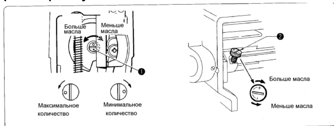
Удалите переднюю пластину и поворотом регулятора количества масла (1), отрегулируйте интенсивность поступления масла к верхней оси.
