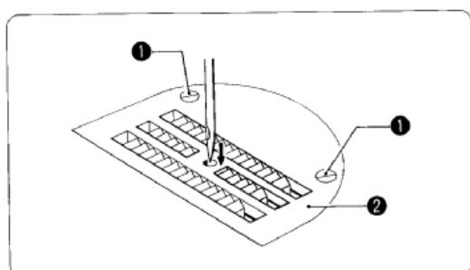
5. Медленно поворачивая маховое колесо, убедитесь, что при опускании игла проходит по центру отверстия в игольной пластине (2).
