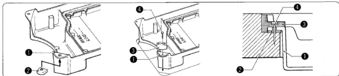
1. Вставьте четыре прокладки (2) в масляный резервуар (1) снизу, так, чтобы четыре угловых отверстия были выровнены.
