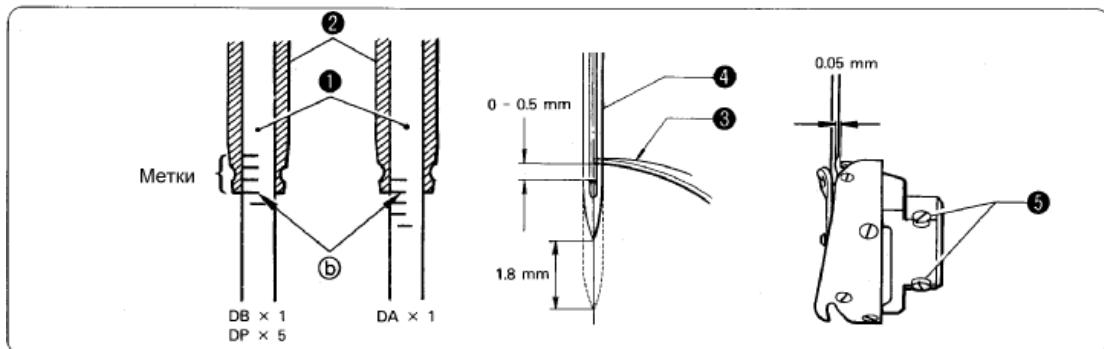
¶ Наконечник вращающегося фиксатора (3) должен быть выронен с центром иглы (4) когда иглодержатель (1) поднимается из своего самого нижнего положения в положение, при котором метка "b", расположенная снизу иглодержателя (1) (третья снизу метка, если используется игла DAx1), совмещается с нижним краем кольца иглодержателя (D) (2), как показано на рисунке.
