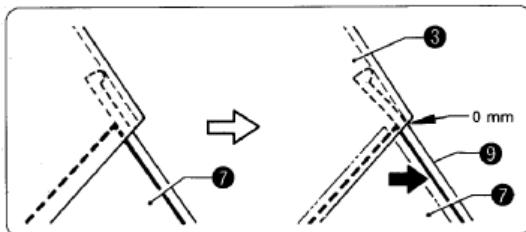
9. Потяните на себя кожух D (7), чтобы исчез зазор между кожухом (3) и крышкой кожуха D (7).
