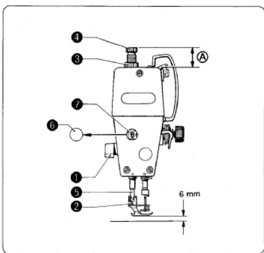
Нормальная высота нажимной лапки (2) равна 6 мм, когда нажимная лапка (2) поднята при помощи рычага поднятия лапки.
