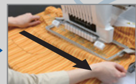
Смещение ткани без снятия пялец с машины
