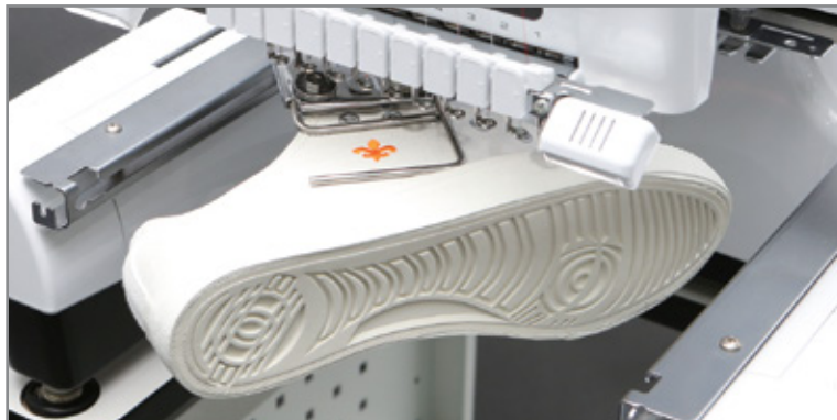
Установка обуви большого размера
