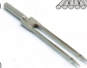
Двойная игла состоит из двух отдельных иголок, соединенные вместе. Игла предназначена для декоративных отделочных швов и защипов. Иглы имеют три размера (70, 80, 90) и три типа (универсальные, для плотных тканей, для вышивания), расстояние между иглами приведено в мм (1.6, 2.0, 2.5, 3.0, 4.0). Чем больше размер, тем больше расстояние между иголками. Номера 4,0 используются только для прямой строчки.
