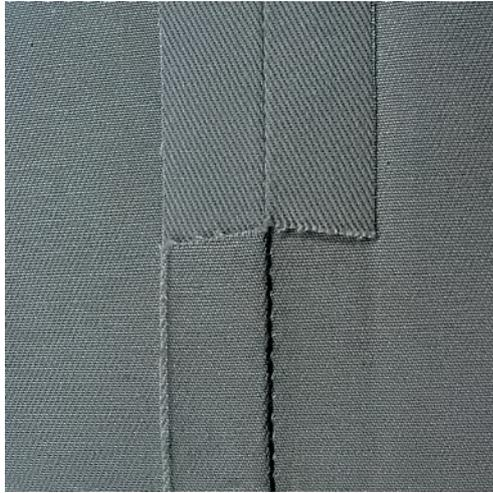
Тройная прямая строчка особенно подходит для износостойких швов и для жестких и плотных тканей, таких как джинсовая ткань и вельвет. При жестких или очень плотных тканях рекомендуется устанавливать лапку для джинсовой ткани № 8. Это облегчит шитье джинсовой ткани или парусины. Для декоративного обстрачивания можно дополнительно увеличить длину стежка.
