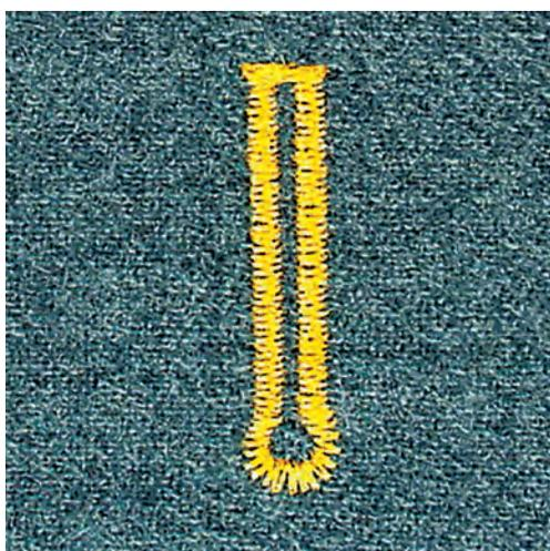
При использовании лапки с салазками для петель № 3А длина петли измеряется автоматически через линзу на лапке. Петля точно копируется, а машина автоматически переключается при максимальной длине. Лапка с салазками для петель № 3А подходит для петель от 4 до 31 мм, в зависимости от типа петли. Подошва лапки с салазками для петель № 3А должна соприкасаться с плоским материалом, чтобы можно было точно измерить длину. Запрограммированные петли имеют одинаковую длину и одинаково красивый внешний вид.
