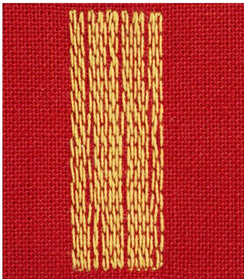
Простая программа штопки № 22 подходит прежде всего для быстрой штопки протертых мест или разрывов. Рекомендуется подклеивать под протертые места или разрывы легкую ткань или тонкую самоклеющуюся ткань. Простая программа штопки № 22 заменяет нити основы на любых тканях. Если поверхность штопки перекашивается, можно выровнять ее функцией баланса.
