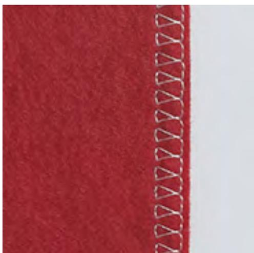
Двойной оверлочный шов подходит для рыхлых трикотажных материалов и в качестве поперечного шва на вязаных изделиях. При шитье трикотажных материалов нужно применять новую иглу «джерси», чтобы не повредить тонкие ячейки материала. При шитье эластичных тканей можно использовать иглу для эластичных материалов.
