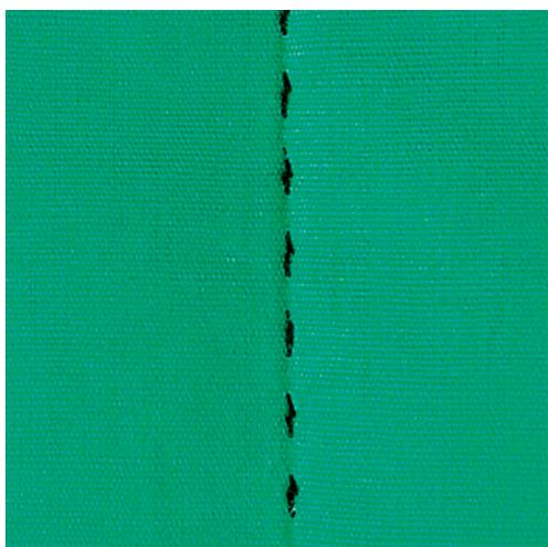
Ручные стежки для квилта подходят для всех тканей и швейных проектов, которые должны выглядеть, как изготовленные вручную. Рекомендуется в качестве верхней нитки использовать нитки из моноволокна, а в качестве нижней нитки нитки для вышивания. Скорость должна быть невысокой во избежание разрыва нитки из моноволокна. При необходимости можно подогнать натяжение верхней нитки и баланс к швейному проекту и к выбранному стежку для квилтов.
