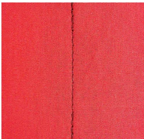
Происходит равномерное закрепление определенным количеством выполненных стежков 6 вперед и 6 назад.
