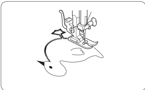
Приметайте аппликацию к ткани (или приклейте утюгом, используя отрывной стабилизатор для машинной вышивки).
