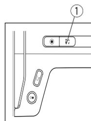
Поднимите прижимную лапку. Нажмите кнопку позиционирования иглы ①, чтобы поставить рычаг нитепритягивателя в крайнее верхнее положение.
