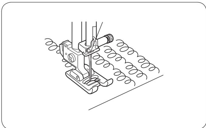
Предварительно запрограммированная строчка свободно-ходовой машинной стежки — быстрая и простая возможность простегать небольшие изделия.
