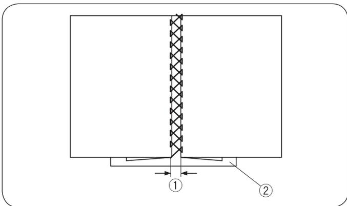
Эта строчка используется для соединения двух деталей изделия с эффектом разрыва в качестве декоративной отделки.
