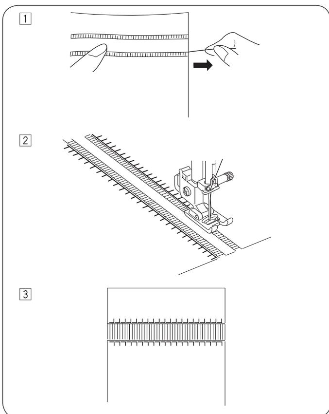
Для мережки используется тот же метод, что и для обработки бахромы. Выбирайте прочную ткань с простым переплетением нитей, например льняную, из которой легко выдергиваются нити.
