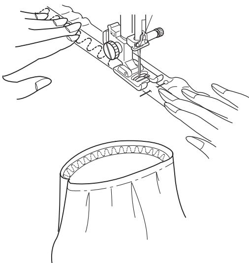
Разделите длину резинки на четыре части и поставьте отметки. Эти отметки совместите с передним и задним швом и с боковыми швами и сколите в этих местах ткань с резинкой.
