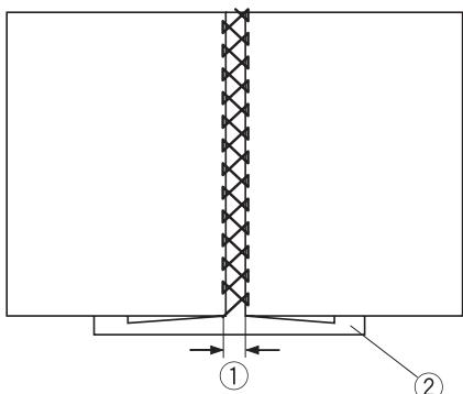
строчек 3. Эта строчка используется для соединения двух деталей изделия с эффектом разрыва в качестве декоративной отделки.
