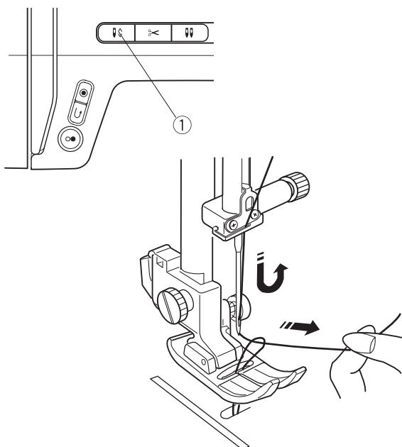
2 Дважды нажмите кнопку позиционирования иглы ①, чтобы поднять и опустить иглу и вытащить нижнюю нить.
