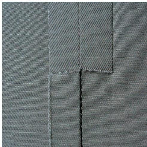
Трехстежковая прямая строчка особенно подходит для износостойких швов и для жестких и плотных тканей, таких как джинсовая ткань и вельвет. При работе с жесткими или очень плотными тканями рекомендуется вставлять джинсовую лапку № 8. Это облегчает работу с джинсовыми тканями или парусиной. Для декоративного простегивания можно дополнительно увеличить длину стежка.
