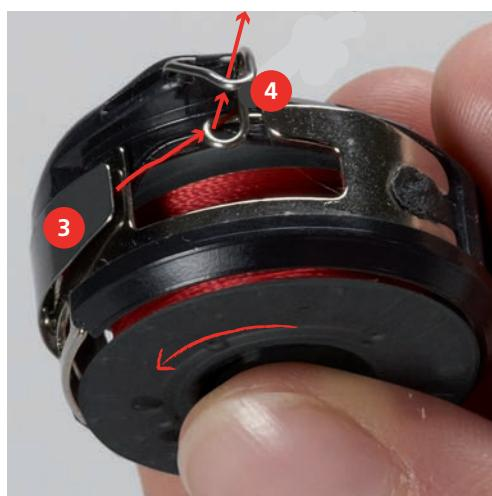
> Чтобы установить шпульный колпачок на машину, держите его так, чтобы нитенаправитель (5) указывал вверх.
