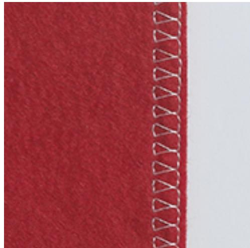
Двойной оверлочный шов подходит для рыхлых трикотажных материалов и в качестве поперечного шва на вязаных изделиях. При шитье трикотажных материалов нужно применять новую иглу «джерси», чтобы не повредить тонкие ячейки материала. При шитье эластичных тканей можно использовать иглы для эластичных материалов.
