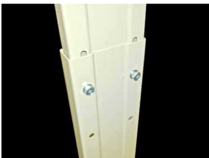
Заводим планку внутрь ноги, крепим её двумя болтами и выравниваем по высоте
