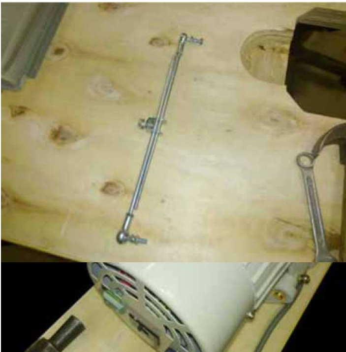
Крепление регулировочной тяги к мотору
