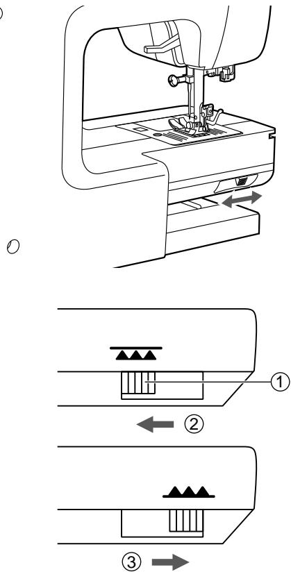
Чтобы отключить транспортёр ткани, передвиньте переключатель в направлении, показанном стрелкой 2 на рисунке. Чтобы поднять транспортёр ткани, передвиньте переключатель в направлении, показанном стрелкой 3 на рисунке, и поверните на себя маховое колесо.
