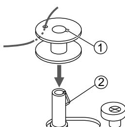
4. Заправьте конец нитки в отверстие шпульки снизу вверх. Установите шпульку на шпиндель намотки.
