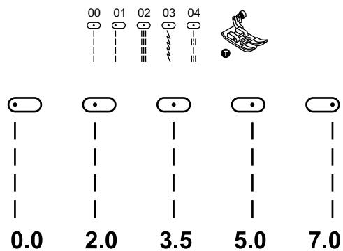
С помощью кнопки выбора ширины стежка можно изменить положение иглы стежком.
