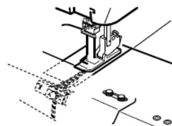
Для достижения наилучших результатов попробуйте шить с различным количеством натяжения на винте большого пальца (G), прежде чем шить вашу настоящую одежду.
