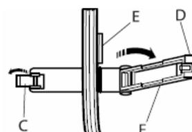
3. Закройте удерживающую пластину (D) и закрепите конец застежки (С). Убедитесь, что резинка находится в пазу (F). Сдвиньте скользящую пластину (H) пальцем так, чтобы удерживающая пластина направляла левую сторону эластичной ленты.
