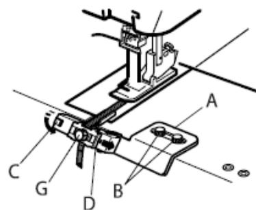
Отрегулируйте величину растяжения резинки, повернув винт большого пальца (G):
