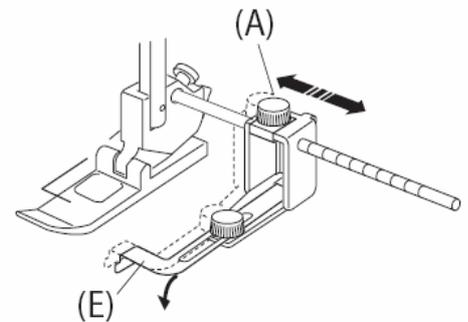
4. Ослабьте винт большого пальца (F) и установите направляющую (E) в соответствующее положение, перемещая ее вперед или назад. Установить ее:
