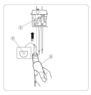
Вставьте новую иглу в фиксатор иглы плоской стороной назад, подтолкните иглу вверх к стопору. Затем затяните винт.
