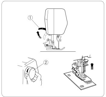
Поднимите рычаг прижимной лапки.
