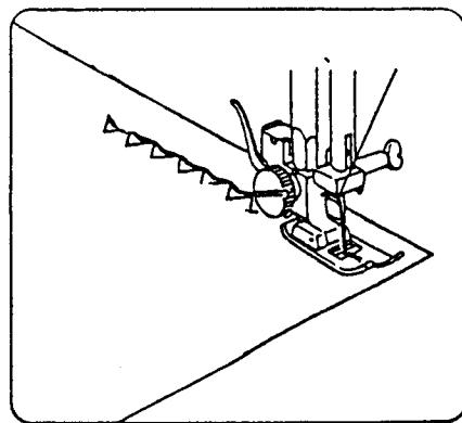
В случае, если не балансируются подачи ткани вперед и назад в зависимости от вида ткани, надо корректировать баланс, поворачивая ручку регулировки длины стежком:
