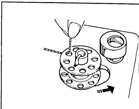
Вытянуть конец нитки с катушки, пропустить нитку через нитенаправитель на верхней крышке машины, провести нитку по нитенаправителю моталки и ввести нитку в отверстие шпульки изнутри наружу. Надеть шпульку на шпиндель моталки и прижать ее вправо.
