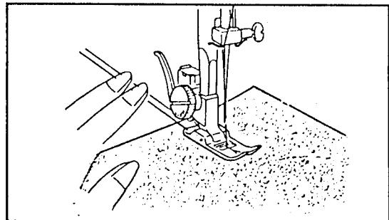
Поднять нажимную лапку и расположить сшиваемую ткань рядом с контрольной линией игольной пластиинки.
