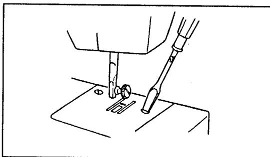
Снять иглу и нажимную лапку.
