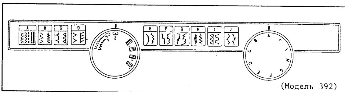
Ширина стежков зигзагообразной строчки ( и ), положение иглы (центральное и левое) при шитье прямой строчкой и в три строчки ( и ) и обмотка петли могут быть выбраны ручкой регулировки ширины зигзагообразной строчки.
