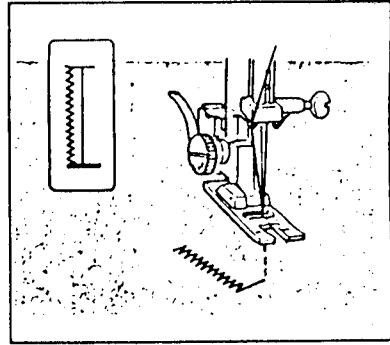
Установить ручку регулировки ширины зигзагообразной строчки в положение "III". Сдвинуть обе нитки влево. Опустить иглу в точку, с которой начать обметку петли, затем опустить и нажимную лапку.
