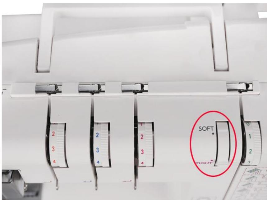
3. На передней панели Cover Pro D MAX нанесена схема подсказок, которая указывает рекомендуемые настройки. Теперь не нужно доставать инструкцию, чтобы посмотреть установки натяжений игольных нитей и нити петлителя. При необходимости натяжения можно менять.
