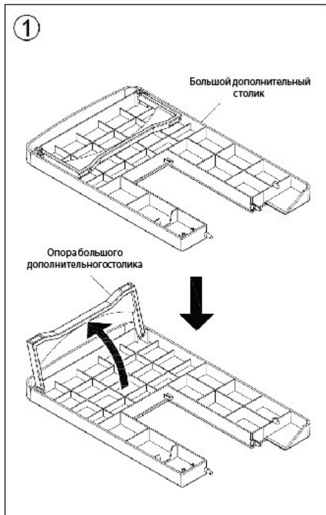
2. Расположите большой дополнительный столик вдоль корпуса машины, как показано на рисунке.
