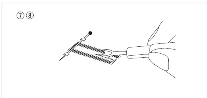
9. После завершения выметывания петли для пуговицы толкните рычаг выметывания петли вверх, как можно сильнее.
