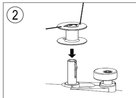
3. Передвиньте шпindelь наматывателя шпульки в крайнее левое положение, если он там ещё не находится. Поместите шпульку на шпindelь. Передвиньте шпindelь наматывателя шпульки вправо до щелчка. Держите за конец нитки.
