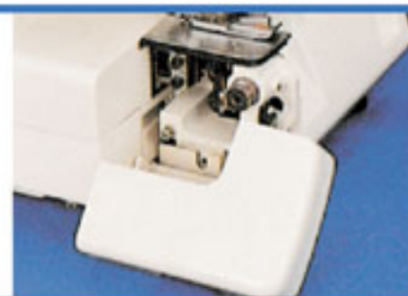
6. Откидной рабочий столик Нажмите на рычаг для опускания столика и доступа к петлителям.
