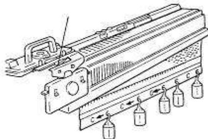
Когда петли сбрасываются на одной половине вязания, отрегулируйте с помощью грузов положение гребенки-грузодержателя в строго горизонтальном направлении.
