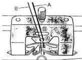
1 - I Установите контролирующие элементы, как указано. Заправьте основную нить "А" и платировочную нить "В" в главный нитеводитель А для набора петель на иглы машины, отобранные в соответствии со схемой резинки 1x1 (KI.PI). Не используйте нитеводитель В для набора петель.
