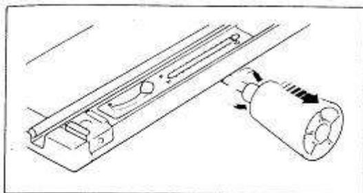
1. Разборка передней игольницы обратна процедуре сборки. Установите индикатор сдвига в положение Н-Ю. Прокручивая, извлеките ручку сдвига из гнезда в направлении, указанном стрелкой.
