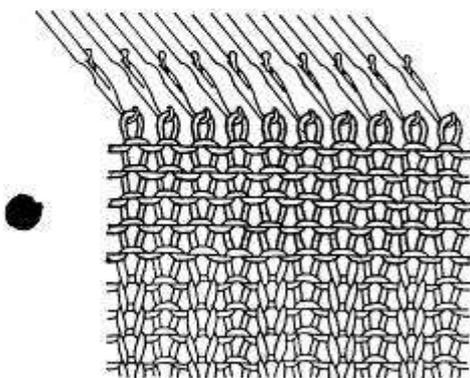
3. Снимите соединительное плечо и укрепите на задней каретке плечо для вязания на задней игольнице и заправьте в нитеводитель контрастную нить. Свяжите 9 - 10 рядов, установив ручку выбора узора на чулочную вязку (0, Λ) и на шкале регулятора плотности число на 4 - 5 единиц большее, чем для вязания двухфонтурного узора.
