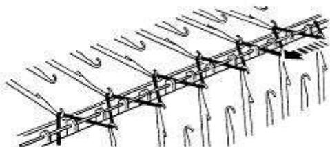
(3) Вставьте спицу через отверстия в зубьях гребенки-грузодержателя.
