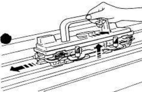
3. Поднимите вяжущий механизм задней каретки, нажав на рычаг высвобождения каретки вправо, и продвиньте каретку в направлении движения до удаления за пределы рабочей зоны.
