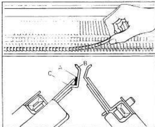
При вязании тонкой или легкой нити, а также при вязании двухфонтурного пресового узора с перфокартой используйте уплотняющую ленту.
