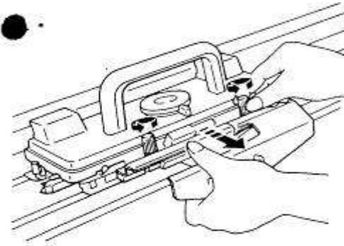
2. Освободите соединительное плечо и снимите его с задней каретки.
