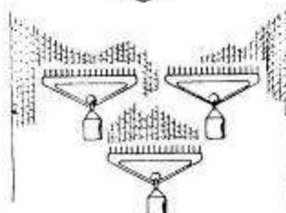
хатель с зажимом, имеющую 50 зубьев, используется для узкого полотна.
