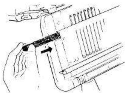
Верните выдвинутую часть фиксатора игл внутрь игольницы. Для этого прижмите плавающие иглы ровной частью отборной гребенки в передней части игольницы.
