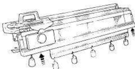
4. Движением иглы вперед и назад провяжите поочередно протяжки нити, висящие над сброшенной петлей, или поднимите сброшенную петлю с помощью петлеуловителя.
