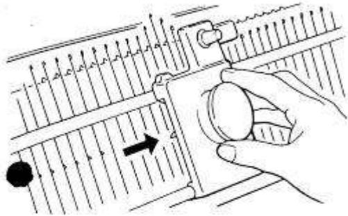
\*Используя П-каретку без П-прижимателя, выдвигайте иглы в положение С перед провязыванием каждого ряда.
