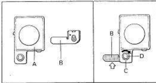
П-каретка используется для вязания тисненого ажюра без П-прижимателя, для вязания махрового полотна-вместе с П-прижимателем.
