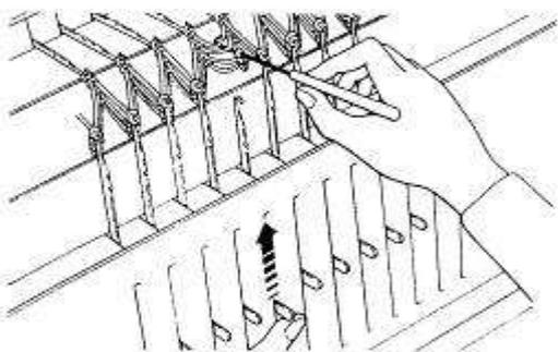
1. Снимите грузы с гребенки-грузодержателя, чтобы предотвратить дальнейшее распускание петельных столбиков.
